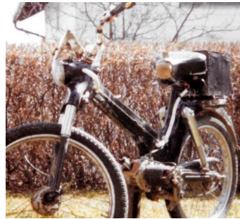
1983: Mofa auf E-Antrieb umgebaut (Reichweite 10 km), 1996 selbst umgebaute Golf auf E-Antrieb (Reichweite 40 km)
