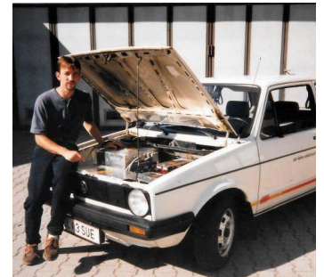
1983: Mofa auf E-Antrieb umgebaut (Reichweite 10 km), 1996 selbst umgebaute Golf auf E-Antrieb (Reichweite 40 km)
